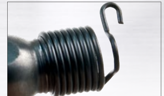
Standardmässiger Federhalter, ermöglicht schnellen Werkzeugwechsel
